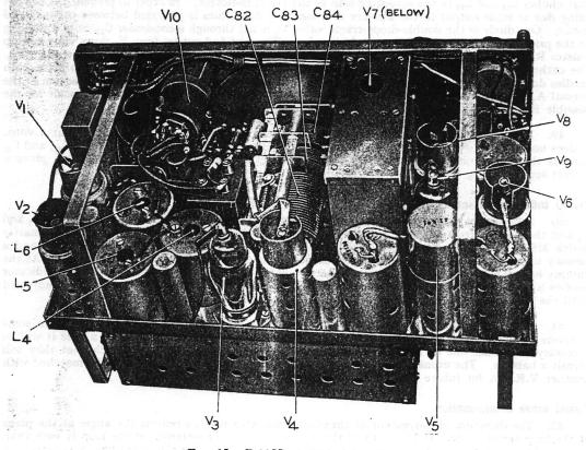
FIG. 15 .- R.1155 CHASSIS, UPPER DECK
